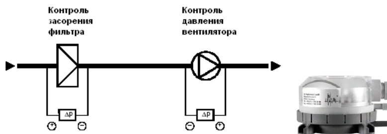
Рис.11. - Внешний вид и примеры использования датчиков давления.
